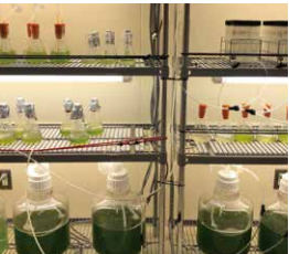
試験管サイズから数ℓボトルサイズの微細藻類培養。微細藻類は光合成を行うので、光をあて、二酸化炭素(数%程度)を通気します。
