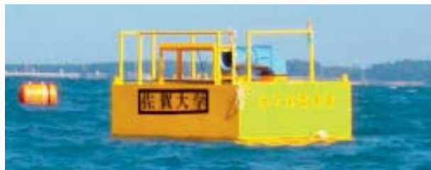
図6／博多湾でのBBDBの実験 また、浮体型の振り子式波力発電装置の開発も行っています。
