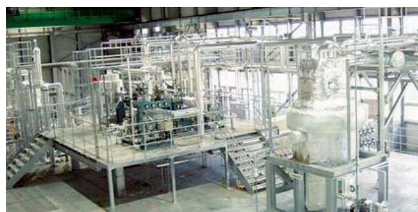
図2／30kW海洋温度差発電装置
