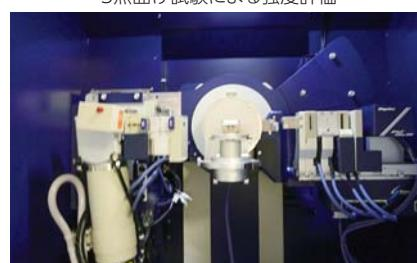
X線回折による残留応力測定
